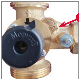
Vollständig geöffneter Bypass für max. Rezirkulation (ausgerichtet auf den Schlitz der Indexraste). 4
